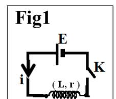
On ferme l'interrupteur K à l'instant  $t=0$  et on enregistre à l'oscilloscope la représentation graphique  $i=f(t)$  (fig2).
