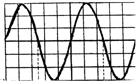
3-2 On relie les extrémités du cadre aux bornes d'un oscillographe. On observe sur l'écran l'oscillogramme de la figure ci contre. En déduire la période et l'amplitude des oscillations ; on donne : balayage horizontal 0,2s/Cm, balayage vertical 21mV/Cm. Les comparer avec les valeurs calculées.
