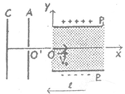
2.1 En O, la particule pénètre avec la vitesse  $\vec{V}_0$  dans une zone où règne un champ électrique dû à une tension U existant entre des plaques  $P_1$  et  $P_2$  de longueur l et distantes de d.
