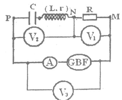
3 On enlève le conducteur ohmique ; le circuit est toujours alimenté par le même générateur, pour une fréquence  $N=N_3=55,7\text{Hz}$  on constate que les tensions efficaces aux bornes du condensateur, aux bornes de la bobine et aux bornes de l'ensemble du circuit sont égales.
