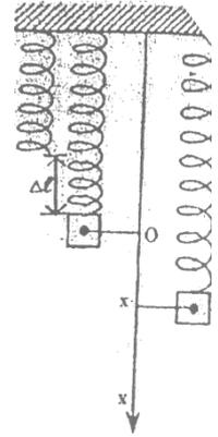
Le ressort s'allonge de  $\Delta l = 2\text{cm}$  lorsqu'on suspend à son autre extrémité une masse ponctuelle  $m = 400\text{g}$ .
