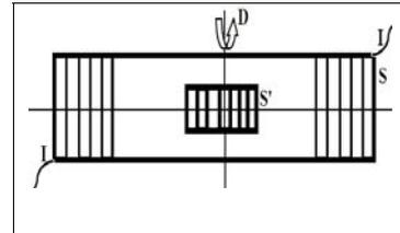
2.3.3 On rétablit dans la bobine  $S$  le courant  $I=2A$  et on imprime à  $S'$  un mouvement de rotation uniforme de vitesse angulaire  $\omega = 10rad/s$  autour de l'axe  $D$  vertical passant par son centre. Donner l'expression du flux magnétique à travers  $S'$  et celle de la f.e.m d'induction. Calculer la valeur maximale de cette f.e.m.
