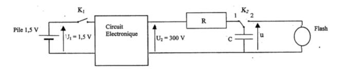
1/ On charge le condensateur en fermant l'interrupteur K<sub>1</sub>, K<sub>2</sub> en position (1)
