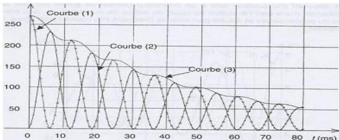
• Les oscillations électriques libres d'un circuit **RLC** série sont dues aux **transformations mutuelles** de ses énergies électrostatique et magnétique.
