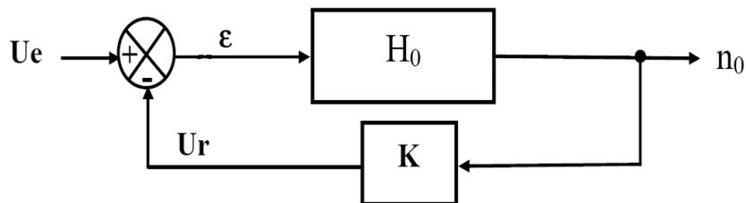
c-1. Déterminer les expressions de la transmittance de la chaîne directe ( $H_0 = n_0 / \varepsilon$ ) ainsi que la transmittance de la chaîne de retour  $K = (U_r / n_0)$ .
